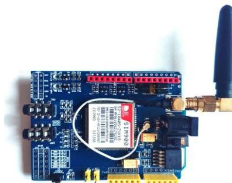
Slika 5.6.1.1. Komunikacioni modul SIM900.
