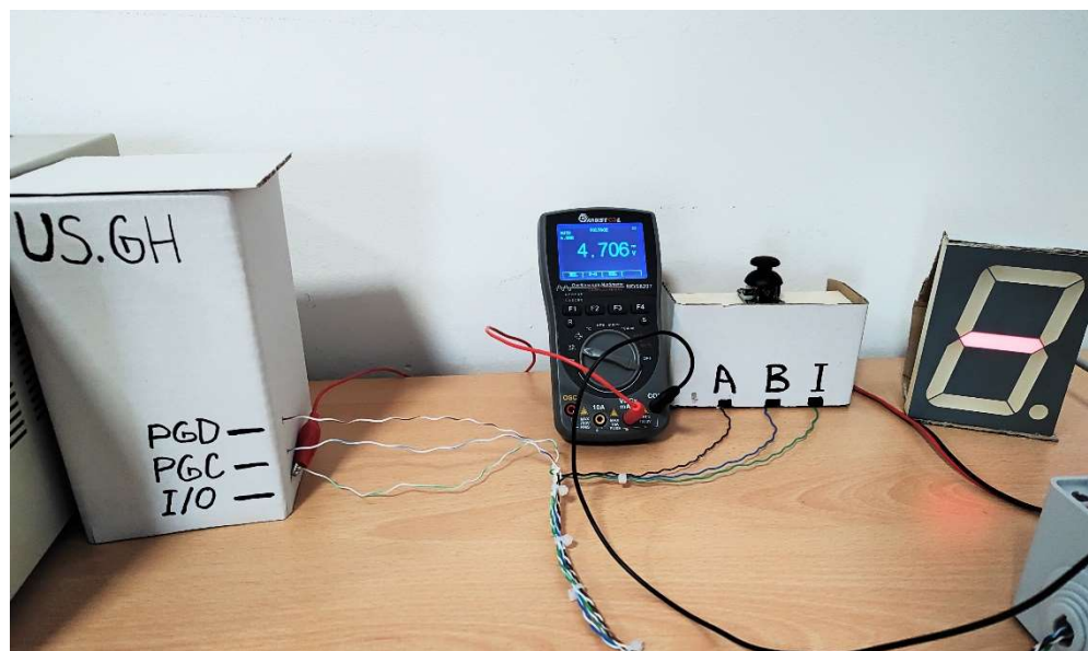
Slika 6.2.2c. Signal automatske zaštite na ulazu I/O.
